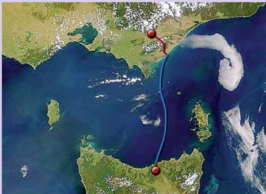
Obr. 4. Nejdelší podvodní elektrický kabel vede stejnosměrný proud a překonává Bassův průliv mezi Austrálií a Tasmánií v hloubce 70 metrů pod hladinou. Podmořský úsek má délku 290 kilometrů. Kabel umožňuje poslat z Tasmánie do státu Victorie v Austrálii až 600 megawattů elektrické energie.
