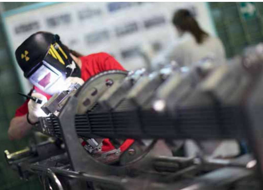
Přivařování koncovky palivové kazety v podniku ELEMAŠ
