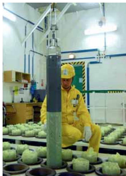
Jaderné palivo ve skladu čerstvého paliva v JE Dukovany
