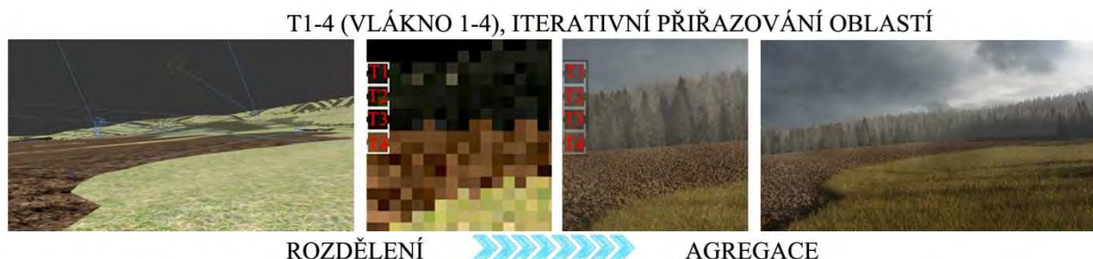
Obr. 2: Paralelizace vykreslení obrazu z 3D modelu.
