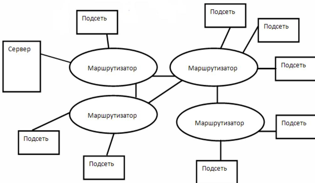
Рисунок 1. Пример структурной схемы сети
