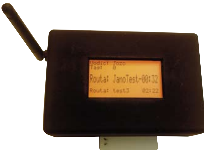
Obr. 5 Vyvinutý mobilný terminál v testovacej prevádzke
