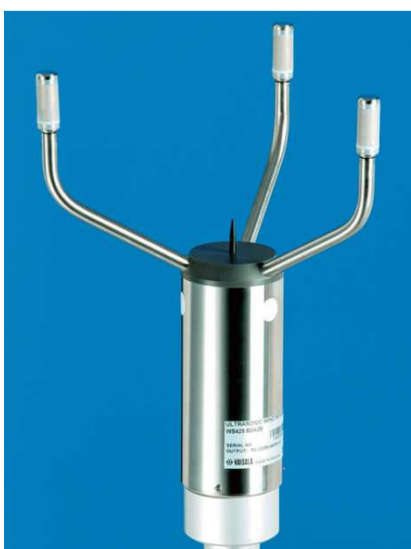
Obrázok 2 – Ultrazvukový veterný senzor [Zdroj: http://www.act-us.info/sensordetail.php?ID=5446&cat=&type= ]
