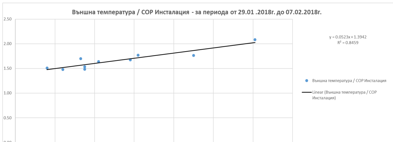
Фигура 11. Функционална зависимост на COP на системата от външната температура при площ на радиационният изпарител 1,6 m 2 (измервания за периода от 29.01.2018 г. до 07.02.2018 г.)
