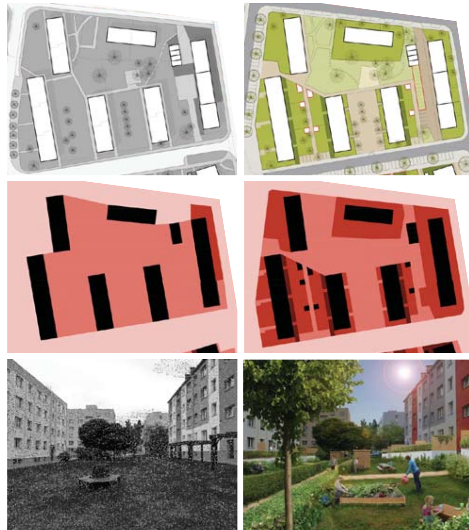
Koncepce úprav sídlišť Spořilov v Jilemnici; uspořádání vnitrobloku se zahrádkami; M. Kohout, D. Tichý, F. Tittl, Š. Doležalová, Centrum kvality bydlení (2015); barevné schéma představuje hierarchii míry soukromí v barevné škále od soukromé (nejtmavší), přes polosoukromou, poloveřejnou až po veřejnou (nejsvětlejší)
